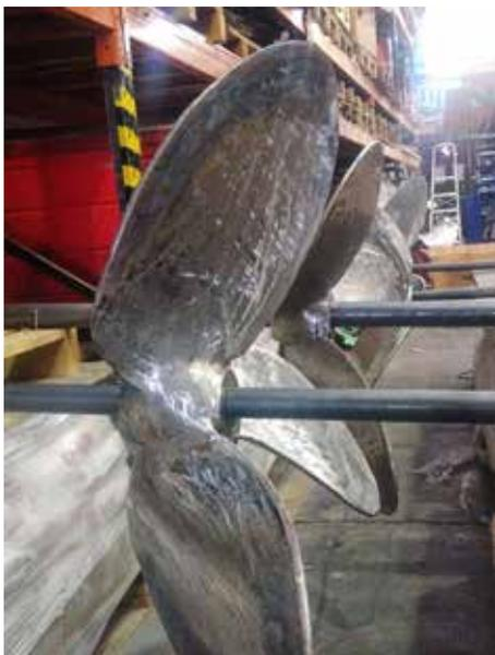
La superficie de las hélices de los agitadores muestran signos de desgaste, cavitación y erosión por lo que se trasladan al taller para su reparación mediante soldadura en frío.
