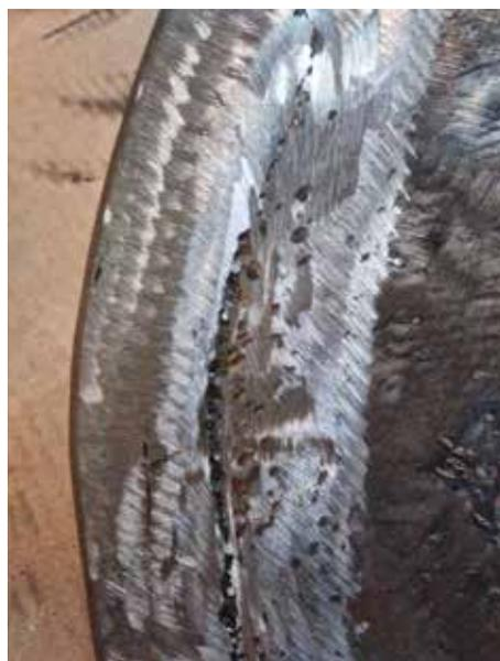
Los puntos donde se ha producido arrastre de material se recargan mediante la aplicación a espátula de la resina epoxi DEVCON Pasta Titanio (HP).
