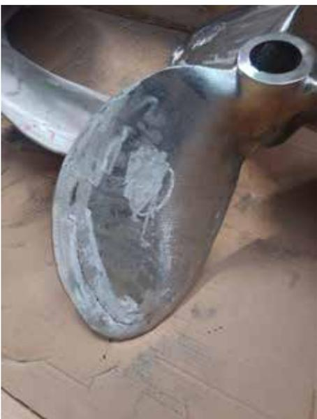
Mediante el lijado superficial de la hélice se genera la rugosidad necesaria para aplicar el compuesto epoxi con carga cerámica DEVCON Cerámico a Brocha.
