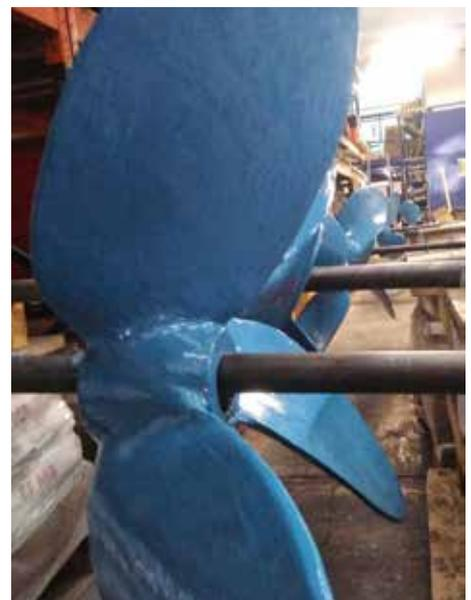
El resultado final de la reparación de las hélices tiene un acabado fino que reduce la fricción. La vuelta al servicio de las hélices fue inmediata.
