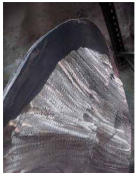
La pasta de titanio DEVCON permite realizar un mecanizado de precisión, lo que facilita conseguir un acabado liso y fino.
