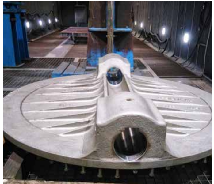
Previamente al inicio del trabajo de reconstrucción, se realizó un granallado superficial de grado Sa 2 ½.
