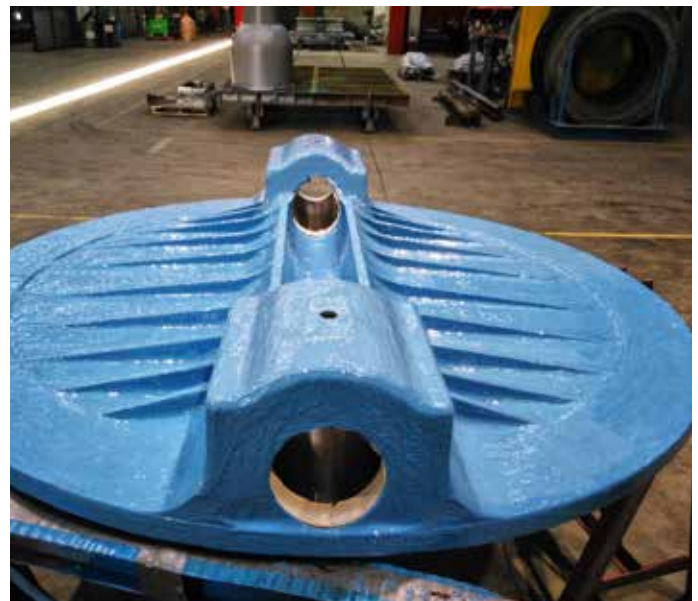
Estado final de la válvula con el recubrimiento cerámico. La fijación del casquillo se realizó mediante inyección de la resina epoxi Chockfast Rojo Líquido.
