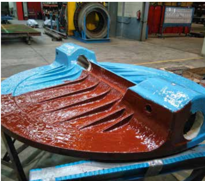
Posteriormente se aplicó el recubrimiento epoxídico de reparación y protección Devcon cerámico a brocha en dos capas, primero en color rojo y después en azul.
