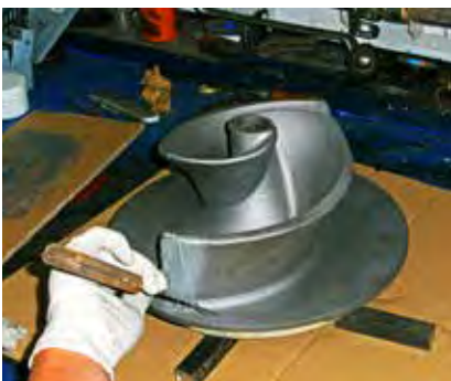
Reconstrucción de impulsor con DEVCON Pasta Titano.
