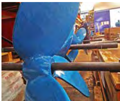
Reparación de hélices de agitadores con DEVCON Titanio y DEVCON Cerámico.
