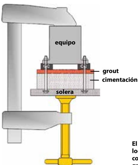
El objetivo de la instalación es lograr un conjunto monolítico compuesto por el equipo, el grouting y la cimentación.
