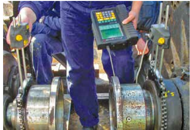
4/ Alineación láser y montaje mecánico.
