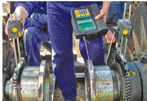
4/ Alineación láser y montaje mecánico.
