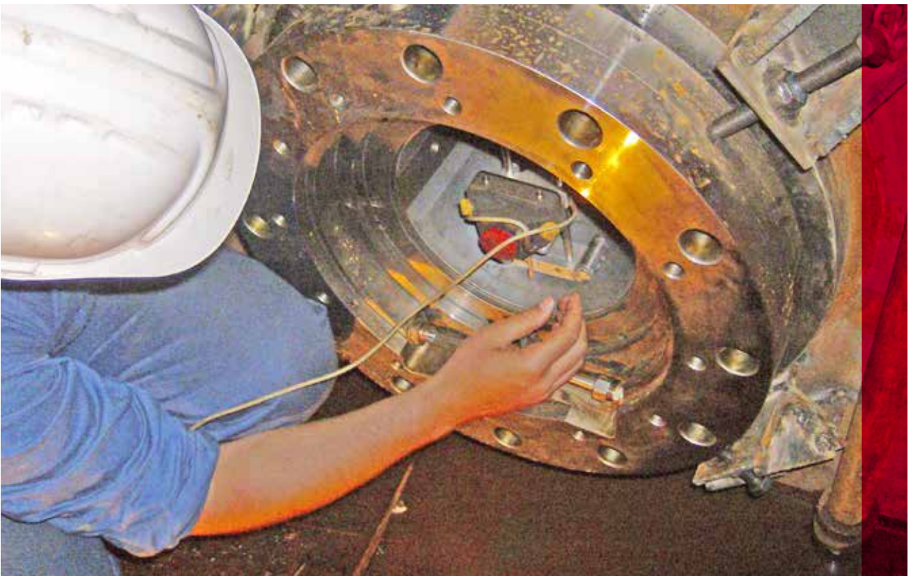
Alineación láser de casquillos de bocina.
