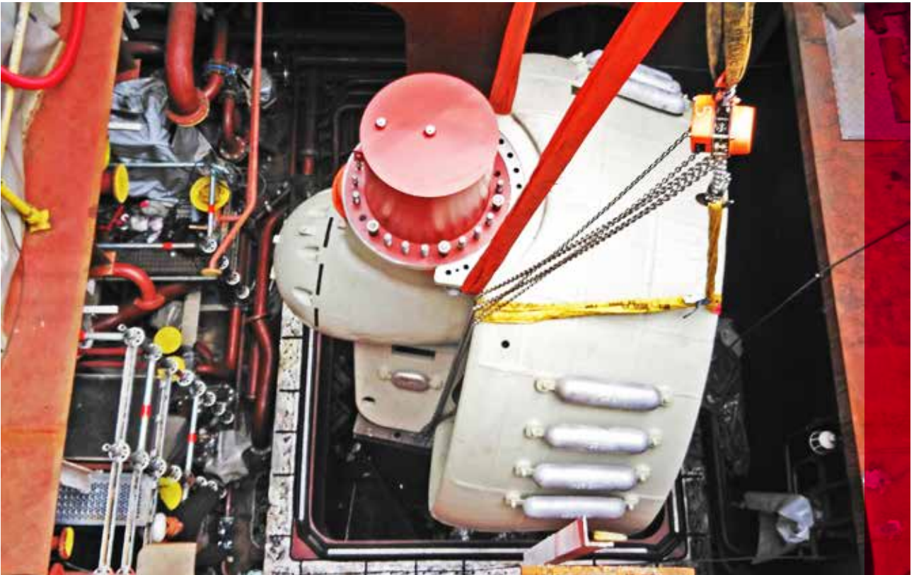
Montaje de la hélice retráctil en el pozo.
