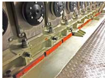
Tacos de resina Chockfast naranja en el Sistema de Asiento del motor principal.
