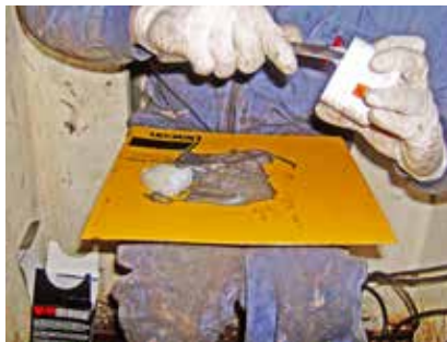
Mezcla de la resina y del activador de la Pasta Acero Devcon A.
