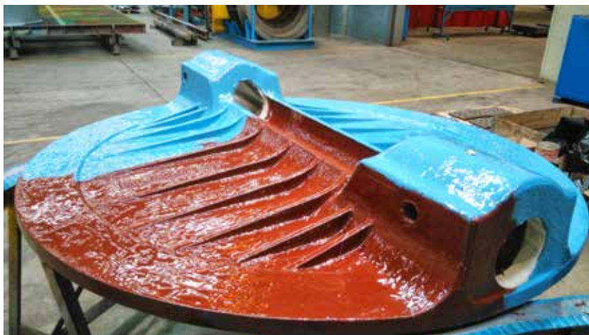
RECUPERACIÓN Y PROTECCIÓN DE SUPERFICIES METÁLICAS, Revestimientos contra el ataque químico, la corrosión y la abrasión.
