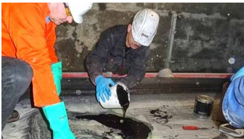
REPARACIÓN DE BANDAS TRANSPORTADORAS, Revestimientos de goma líquida o uretano para reparar daños por abrasión.
