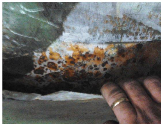
Detalle del daño en la superficie metálica desgastada por corrosión y abrasión.
