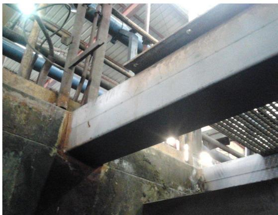
Celdas de flotación en una mina dañadas por corrosión y abrasión.
