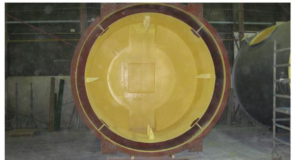
Resultado de la aplicación del recubrimiento Irathane 155HS en celda de flotación.
