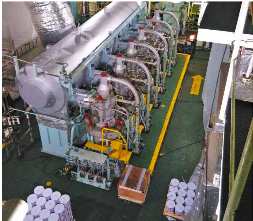
Motor de dos tiempos en proceso de reparación del taqueado de resina.
