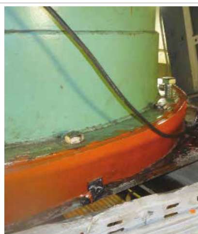
Taqueado del motor con Chockfast Naranja.
