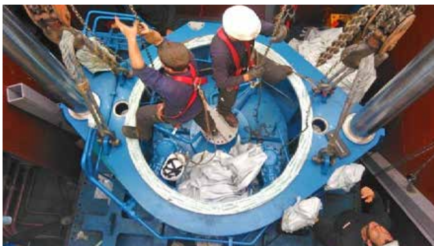
Montaje de hélice retractil con resina Chockfast Naranja.
