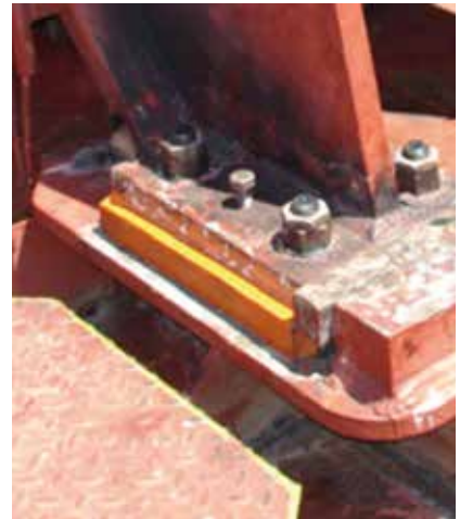
Detalle del taqueado del molinete.
