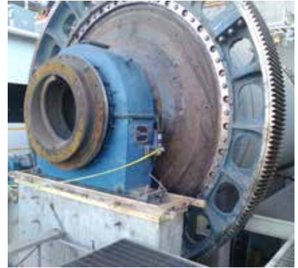
Rehabilitación de bases de molino con resina epoxi Chockfast Rojo . Unidad "La Encantada", Grupo First Majestic, Coahuila, México.
