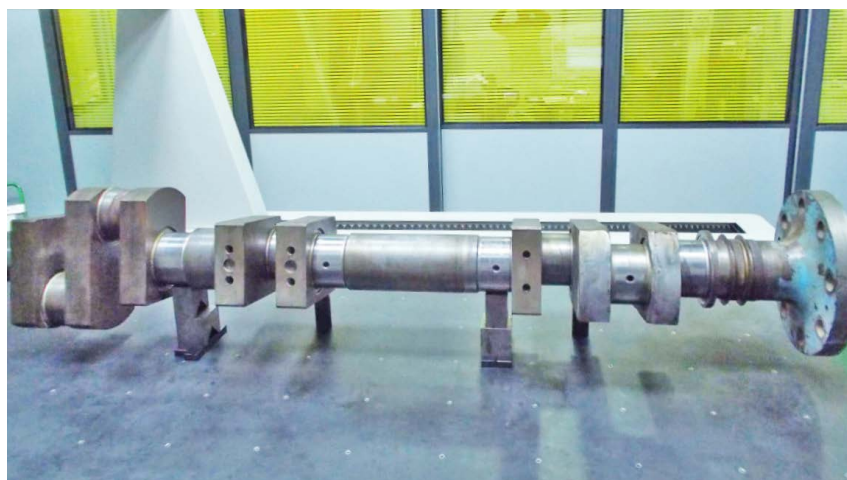
Control de cigüeñal en centro de verificación.
