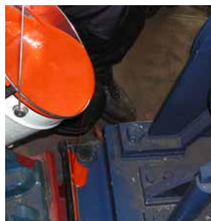
Vertido de la resina epoxi a temperatura ambiente
